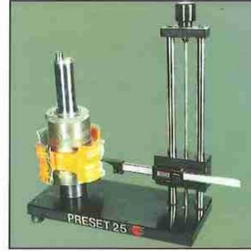
Das neue Werkzeug-Messgerät, PRESET 25, erlaubt eine schnelle und präzise Messen des Werkzeughalters: die Einstellung von Superset 23 wird noch rascher.
