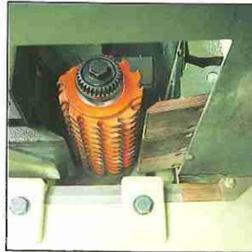
Der Gliederdruckschuh vor der oberen Horizontalspindel übt der gleichmäßigen Druck auf jedem Werkstück, ohne Rücksicht auf den Abmessungen, aus: die Oberflächenqualität ist somit konstant.
