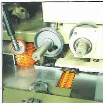
Die gehärtete Einlage im Einlaufstich bringt einen niedrigeren Verschleiß und leichteren Werkstückvorschub.
