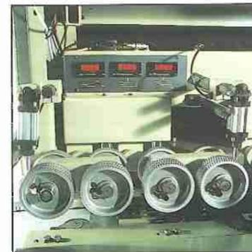
Die verzahnten Vorschubwalzen gewährleisten eine optimale Adhäsion auf dem bearbeitenden Werkstück: die besondere Form der Zähne beschädigt das Werkstück nicht und bewahrt dieselben Vorschubleistungen für immer.
