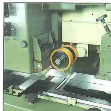
Im Maschinentisch befinden sich angetriebene Vorschubwalzen, die den Werkstückvorschub auch bei schwierigen Arbeitsbedingungen garantieren, wie z. B. bei harzhaltigen Hölzern oder bei großer Spanabnahme.
