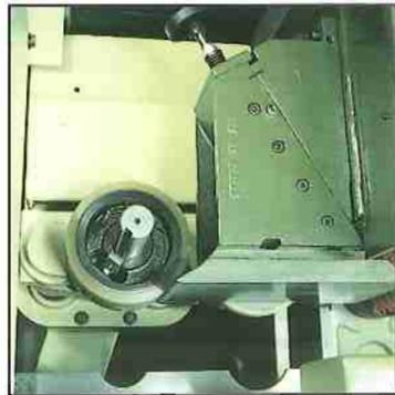
Der Druckschuh nach der oberen Horizontalspindel hat auch eine «schräge» Bewegung um einen gleichmäßigen Druck auf dem ganzen Werkstück auszuüben und eine optimale Feinbearbeitung zu erreichen.
